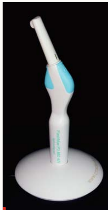
Zdj. 9. Lampa FlashMax P3 na podstawie ładowarce. Widoczne błękitne włączniki na obu powierzchniach podstawy głowicy
